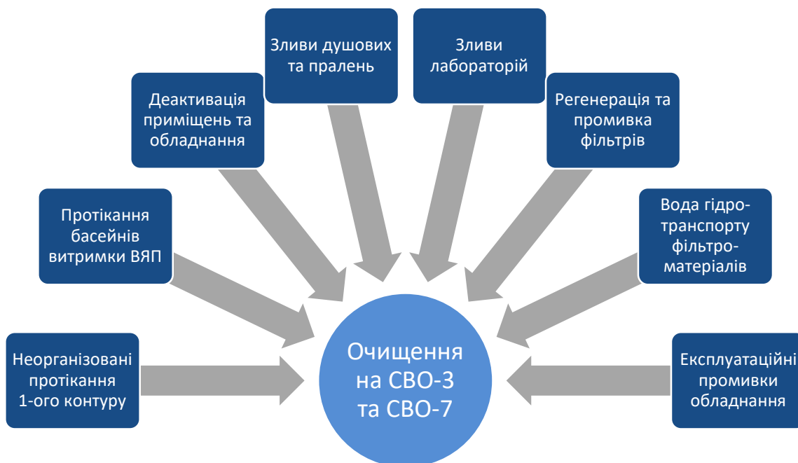
Джерела утворення трапних вод на АЕС
